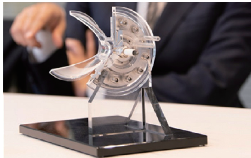
유기정밀이 제조한 로켓 엔진 연료분사 장치
