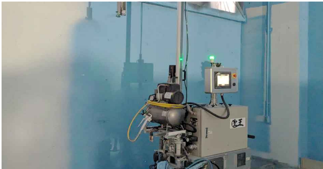
<그림 3> 다께노베가 개발한 도장용 로봇의 도장 작업
