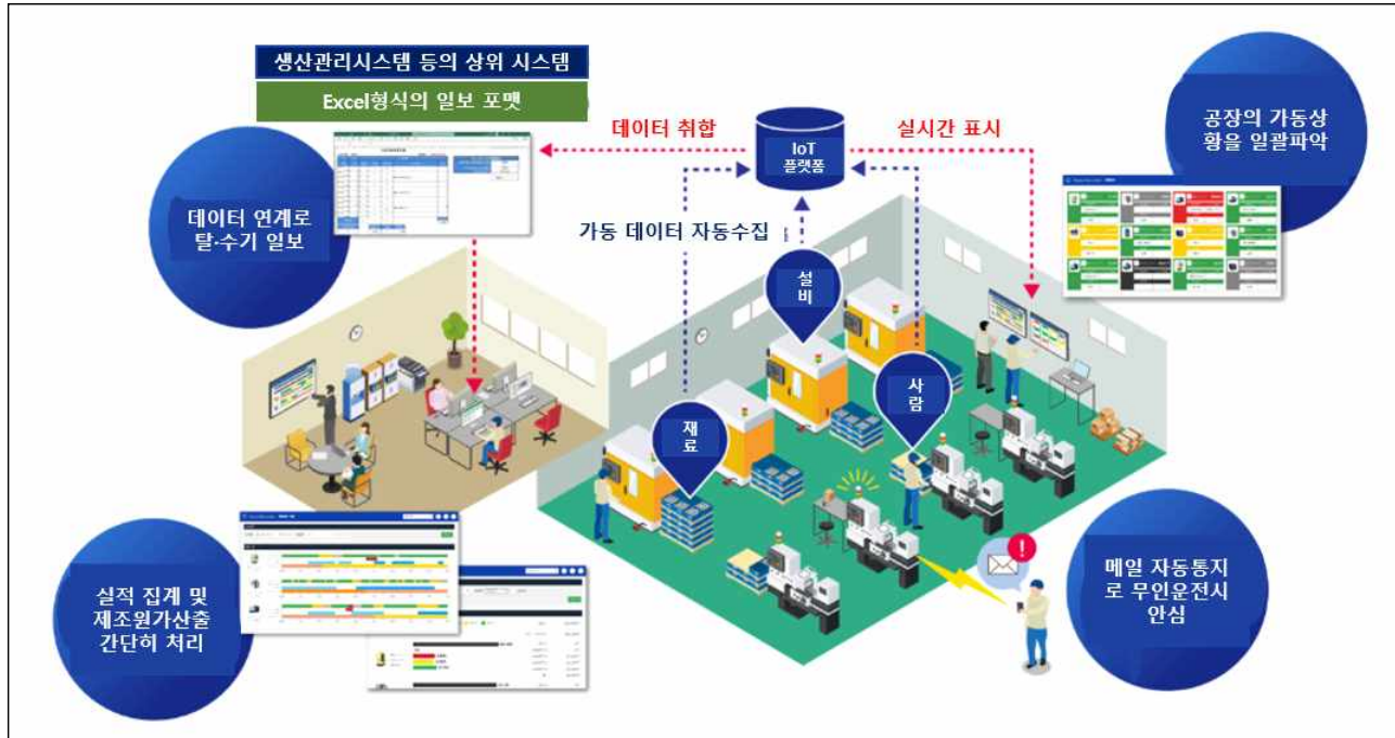
〈그림 3〉 스바루공업의 원격가동감시시스템의 구성도
