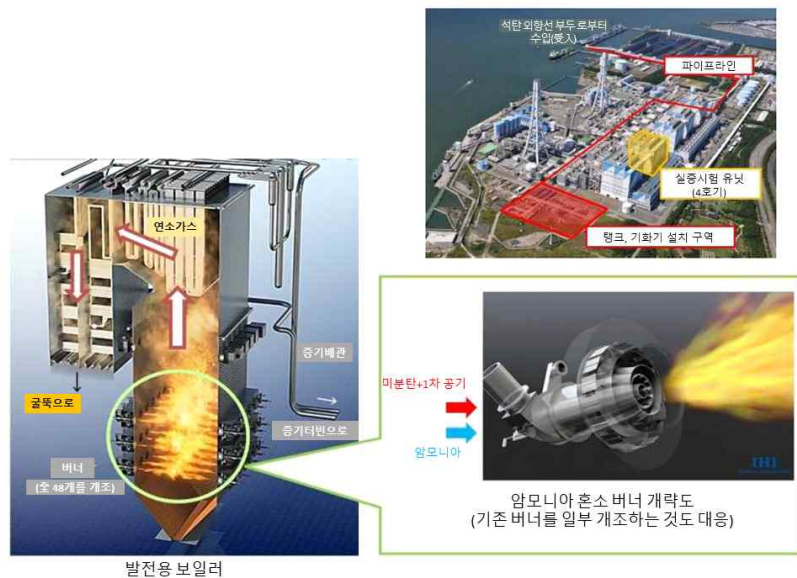
〈그림 3-10〉 석탄화력발전 실물에 20% 암모니아 혼소 실증사업
