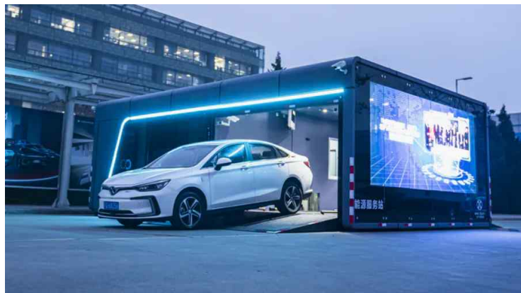
<도표49> Blue Park Smart energy Technology 배터리 교환 스테이션
