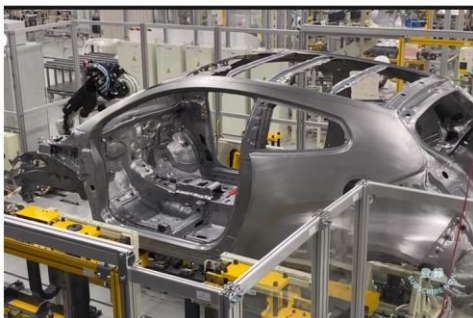
차체 조립 단계에서의 로봇에 의한 치수 측정 출처) 도요타 유튜브
