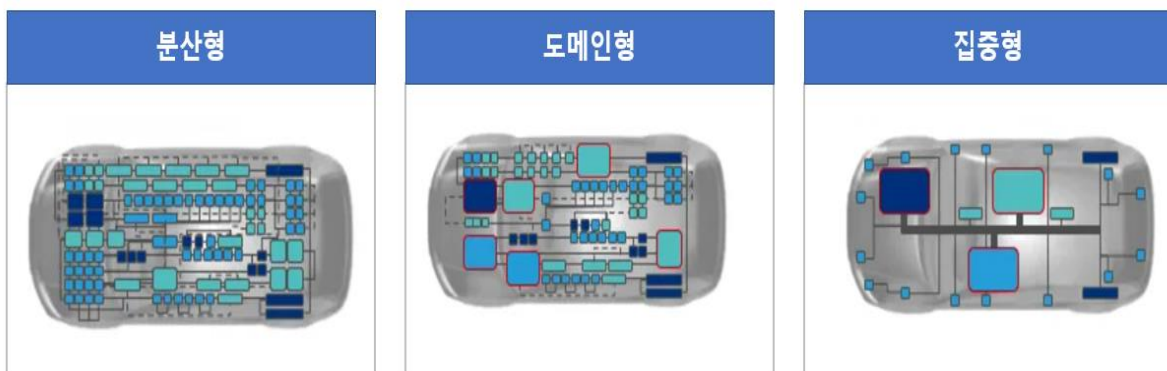
<도표22> 자동차 전기전자 시스템의 진화
