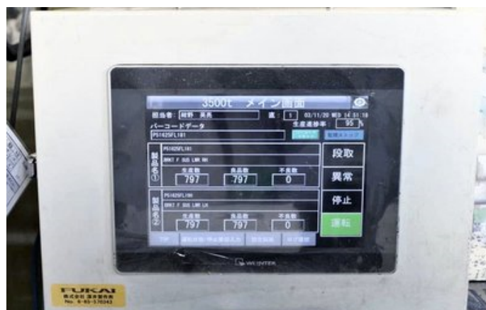
(사진) 트랜스퍼 프레스기(3000t)의 가동관리화면, 가동 데이터는 사무소의 단말에 집약됨.
