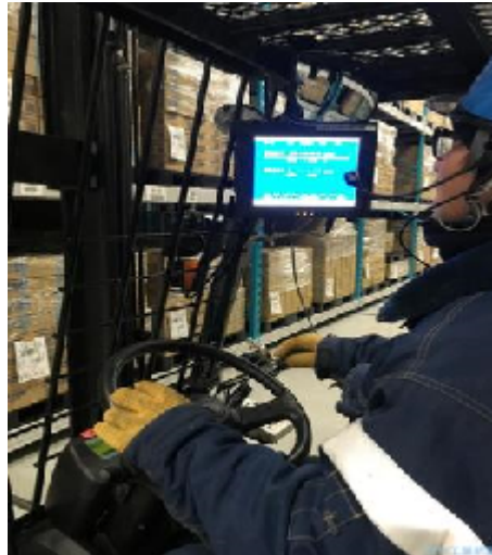
(사진) 냉장 창고 내의 포크리프트 작업과 전동식 이동 랙이 연동되는 카고 내비게이션 시스템
