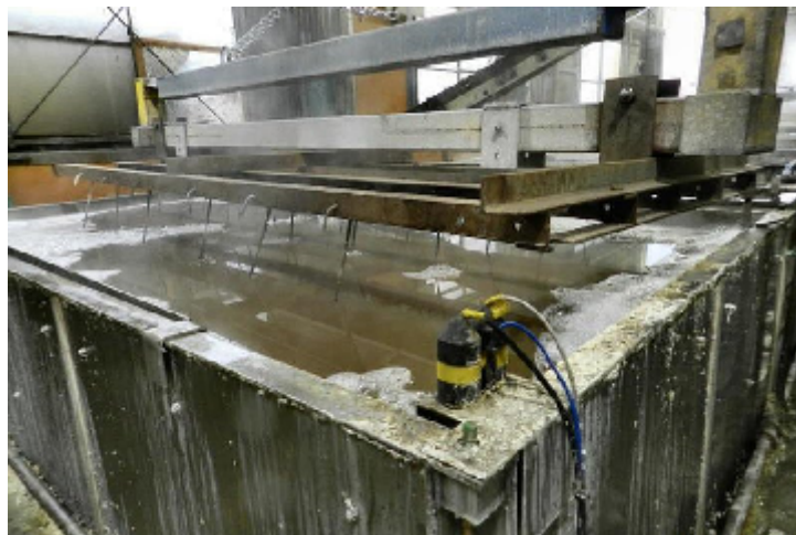
(사진) 원격감시를 위한 센서(사진 중앙)를 설치한 도장전 처리공정의 액체 탱크
