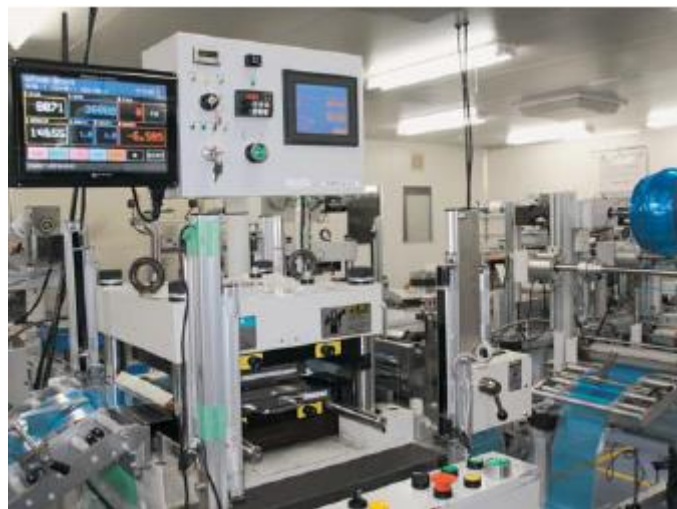
(사진) 센서와 모니터를 부착한 프레스 가공기. 가공수·지시수·불량수 등을 표시.
