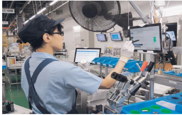
(사진) 표시되는 지시사항에 따라 부재 수집이나 조립을 실시해 작업 미스를 미연에 방지
