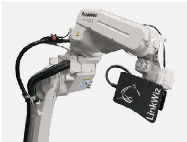
(사진) 용접 부분을 검사하는 로봇
