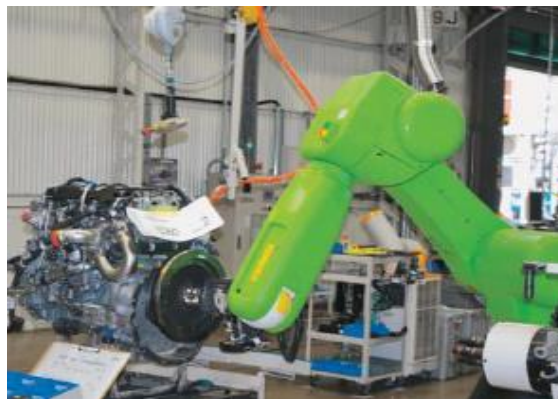
(사진) 소형 엔진의 플라이 휠 조립 공정에서 협동 로봇을 도입
