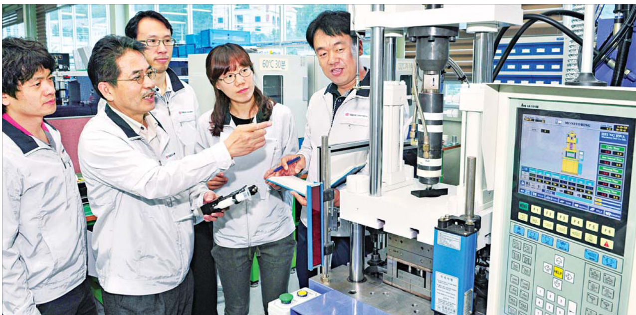
니시자와 도시미치 태하 기술고문(왼쪽 두 번째)이 경기 남양주시에 있는 본사 3층 기술연구소에서 액체정량 공급장치에 쓰이는 스테이터용 특수 고무 사출성형기 작동 상황을 점검하고 있다. 남양주=강은구 기자 egkang@hankyung.com
